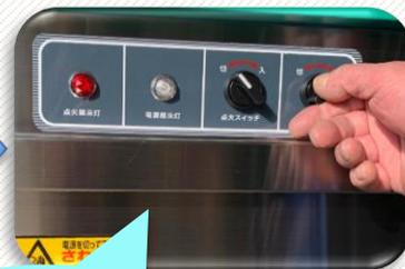
**\* 注意:**コックの水抜き後にスイッチを入れて10秒ほど空転することにより、ポンプやホース、ガンに残っている水を飛ばしてください。これをしないためにポンプを凍らせてしまう事象が多発しています。
