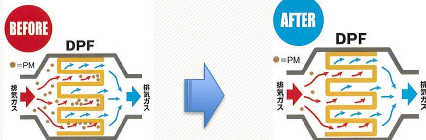
エンジン内の燃焼温度が正常に戻り、溜まっていたPM(スス)がどんどん燃焼され、DPFの強制再生の回数と再生時間が新車並みに戻ってきます!
