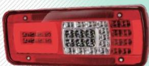
**LC11** Iveco/MANのトラック向けに開発された初の面発光タイプのフルLEDテールランプ
