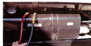
※燃料タンクの送りのホースと戻りのホースを外して専用器具に接続
